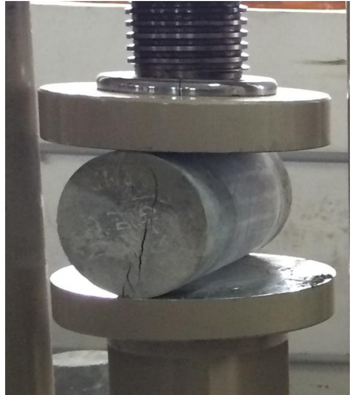
Fig.4.6. Tensile Test specimen
