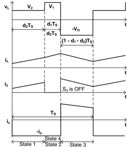
**Figure 4:**  $V_L$ ,  $i_L$ ,  $i_3$  and  $i_C$  waveform
