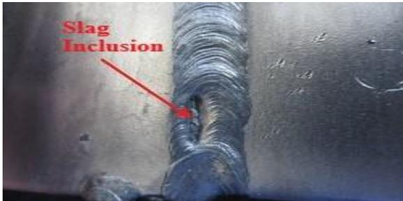
Figure 4. Slag Inclusion Photo<sup>[11]</sup>
